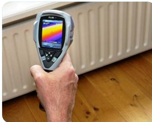
Meetmethode met warmtebeeldcamera
